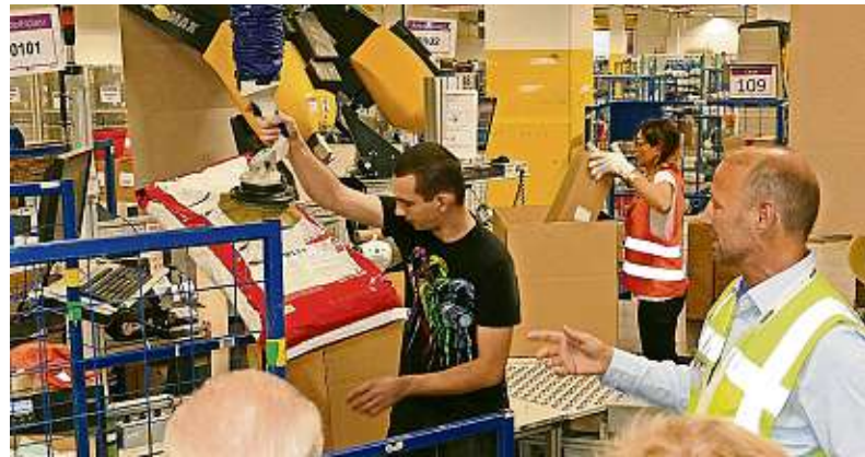
Alexander Bruggner (rechts) mit Mate Stranzki, der einen Vakuumheber bedient.
